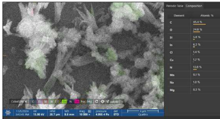
Рис. 2. EDS анализ поли-CuT(4-NH 2 Ph)P на поли-MnCIT(3-NH 2 Ph)P, осажденных из растворов порфиринов в ДХМ с анилином.
