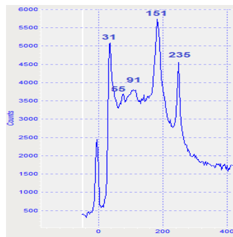
Рис. 1. Рамановская спектроскопия электрохимически осажденных тонких пленок \text{Sb}_2\text{Se}_3 .
