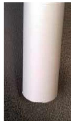
Рис. 3. Образец, анодированный после предварительного травления в растворе  $\text{NH}_4\text{F} \cdot \text{HF} + \text{NH}_2\text{OH} \cdot \text{H}_2\text{SO}_4$
