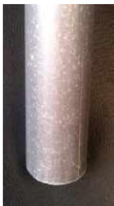
Рис. 2. Образец, анодированный после предварительного травления в растворе  $\text{NaOH} + \text{NaCl}$
