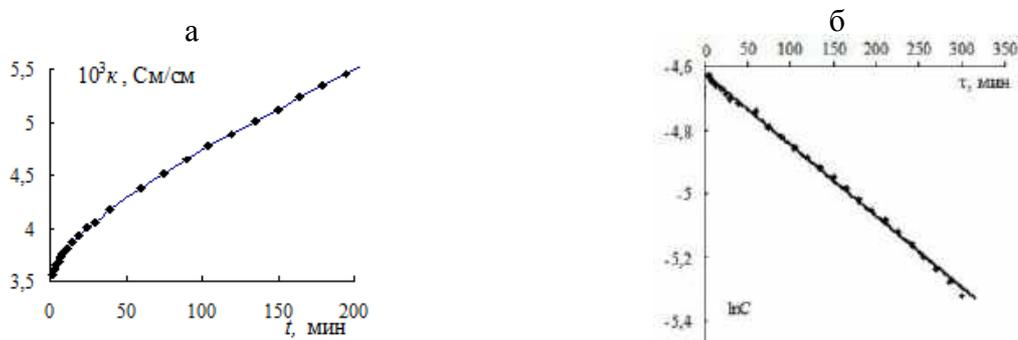
Рис. 2. Возрастание удельной ЭП в процессе взаимодействия дофамина с персульфатом калия (а) и зависимость логарифма концентрации дофамина ( $\ln C$ ) от времени ( $\tau$ ) для реакции окисления ДА; температура 25 °С
