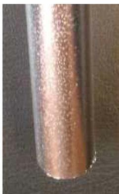
Рис. 1. Образец, анодированный после предварительного полирования в растворе  $\text{H}_3\text{PO}_4 + \text{NH}_4\text{NO}_3$
