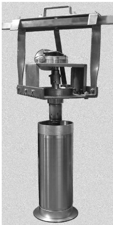
Хромирование в размер крупногабаритных стальных тел вращения (типа плунжера), диаметром 100 мм и более, весом до 25 кг, вызывает серьезные трудности, и связаны с необходимостью существенно увеличить припуск слоя хрома на операцию шлифования, даже если оснастка позволяет производить поворот детали в ходе хромирования.
