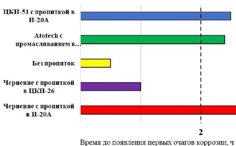
Рис. 1. Результаты коррозионных испытаний
