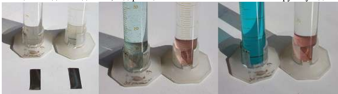
Рис. 1. Снятие покрытия из сплава олова со свинцом азотнокислым раствором без (левая часть фотографий) и с новой ингибиторной добавкой (правая часть фотографий).
